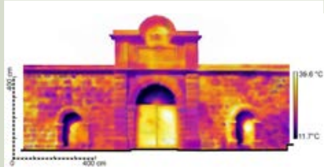
Şekil 3. Ferit Paşa su deposu cephesine ait sıcaklık değişimlerinin termal görüntüsü (İnce vd., 2018).
