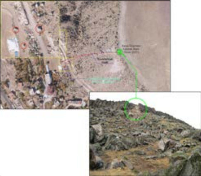
Şekil 12. 2011 yılında meydana gelen kaya düşmesi ve ortofoto üzerinde blok hareketinin gösterimi
