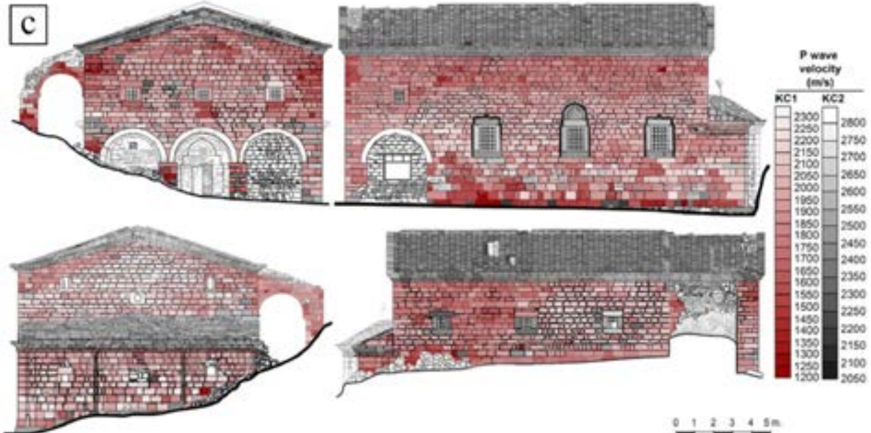
Şekil 7. P-dalga hızı testi; a) portatif cihazla ölçüm alınması (Hatır, 2019), b) laboratuvar tipi cihazla ölçüm alınması (Hatır, 2020), c) P-dalga hızı testi değişim haritası (Hatır vd., 2019).
