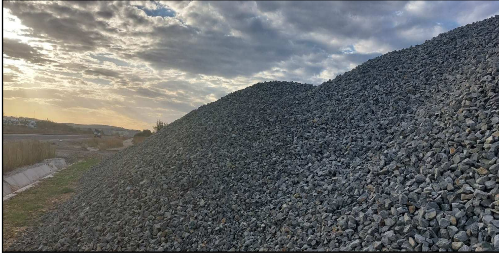
Şekil 6. Karacaören bazaltlarından üretilen balast malzemesinin yığın görünümü.
