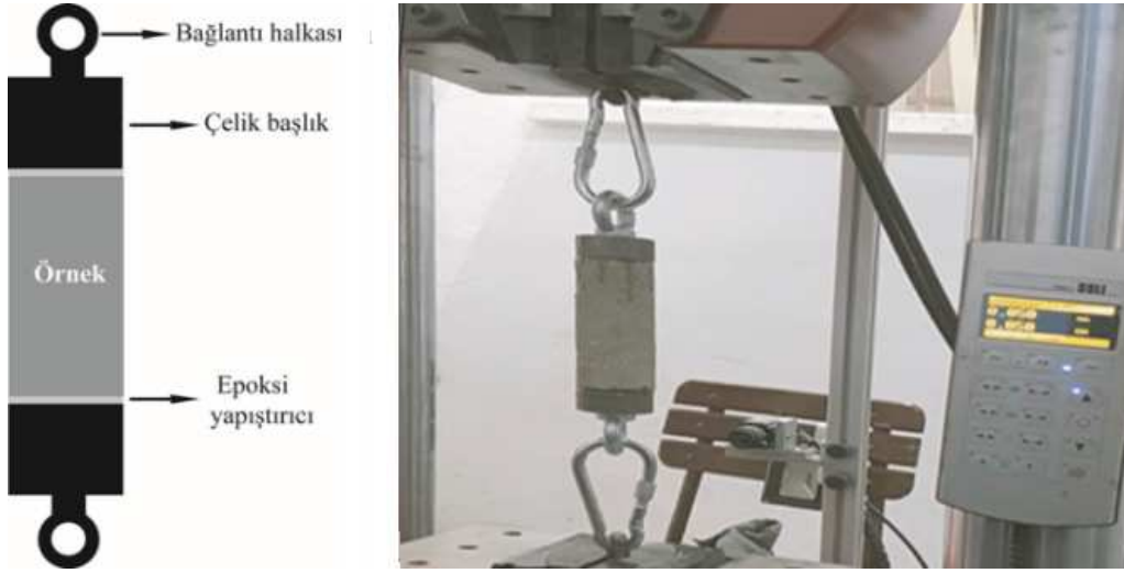
Şekil 4. Doğrudan deneyin şematik gösterimi (a) ve deneyin gerçekleştirilmesi (b).
