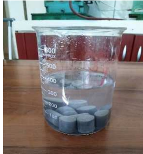
Şekil 5. Kürlenmiş agrega taneleri.
