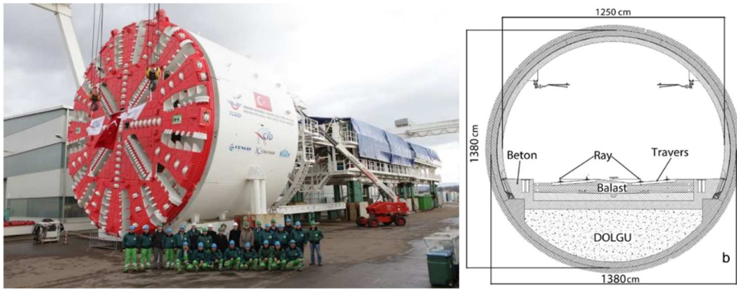
Şekil 2. Tünel kesitleri (a: Klasik kazı tünel kesiti, b: TBM tünel kesiti).
