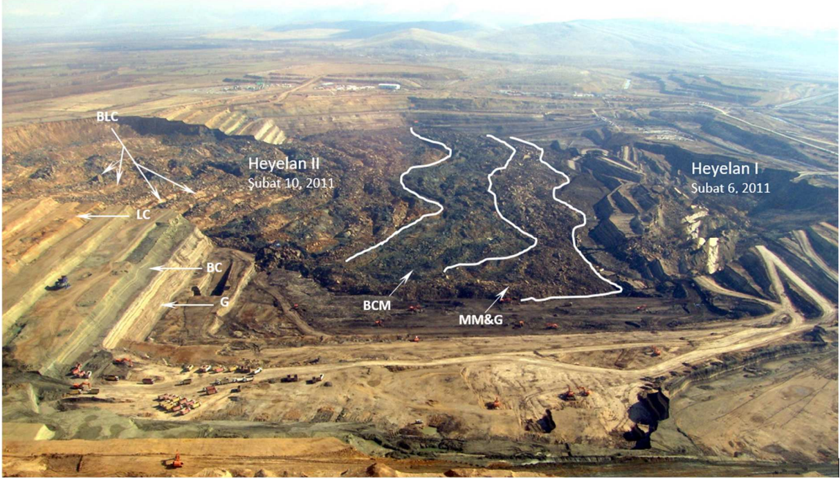
Şekil 2. Ardışık heyelanların ve morfolojilerinin hava fotoğrafı (güneydoğuya bakış).G: Gidya, BC: Mavi Kil, BCM: Mavi Kil Çamuru, LC: Kuvaterner gösel karbonatı, BLC: Mavi kil içinde yüzen LC blokları, MM&G: Gidya ile karışık malzeme.
