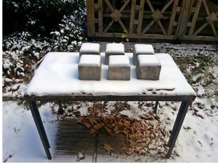
Şekil 7. Dış ortam testindeki kireçtaşı agregası ile üretilmiş bloklar ve uçucu kül agregası ile üretilmiş bloklar.
