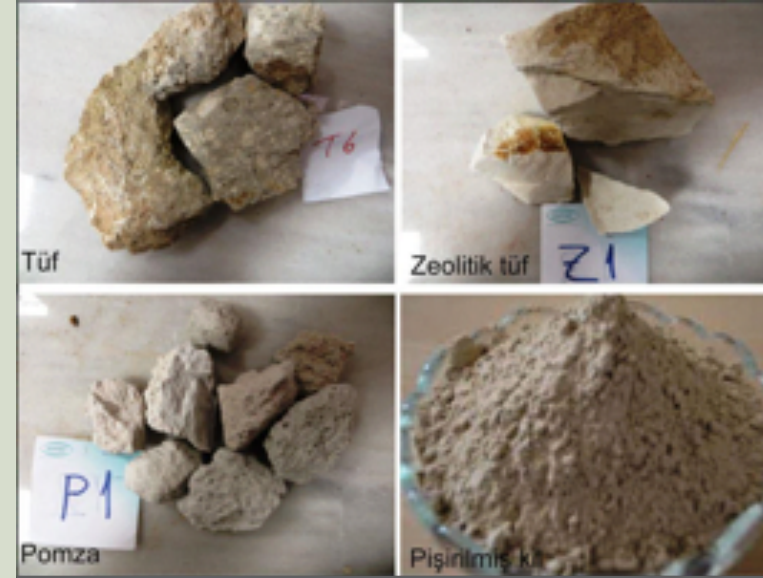
Şekil 1. Farklı kaynaklardan elde edilmiş doğal puzolan örnekleri. (Tuf, Zeolitik Tuf, Pomza, Pişirilmiş Kil).
