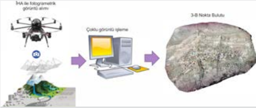
Şekil 8. İHA ile alınan fotogrametrik görüntülerden nokta bulutu oluşturulması (Akın vd., 2020)
