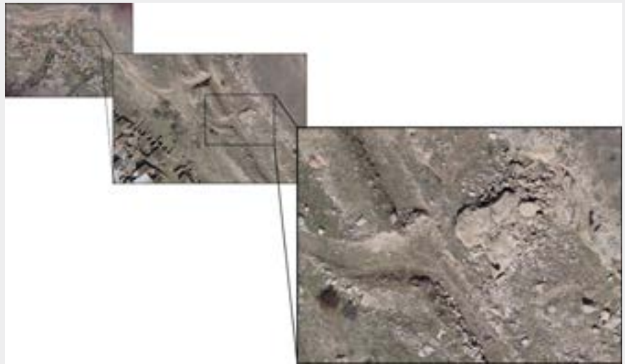
Şekil 9. Nokta bulutlarından elde edilen sayısal yüzey modellerinde önceden düşen blokların tespiti (Akın vd., 2018).
